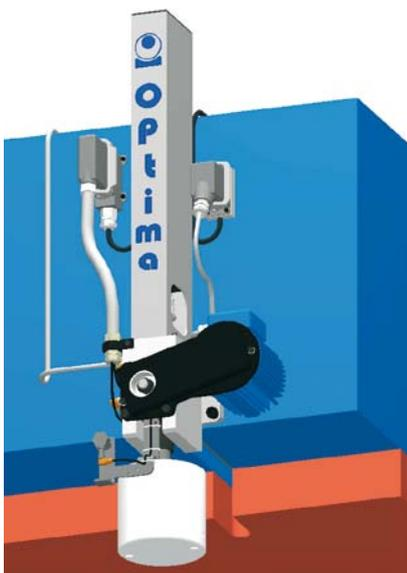
本品由四个带法兰的内六角螺栓实现固定 (DIN6921), M10x30, 强度等级 8.8 以及两个弹簧定位销 8.8 (DIN1481) #8x20 (需另配).
